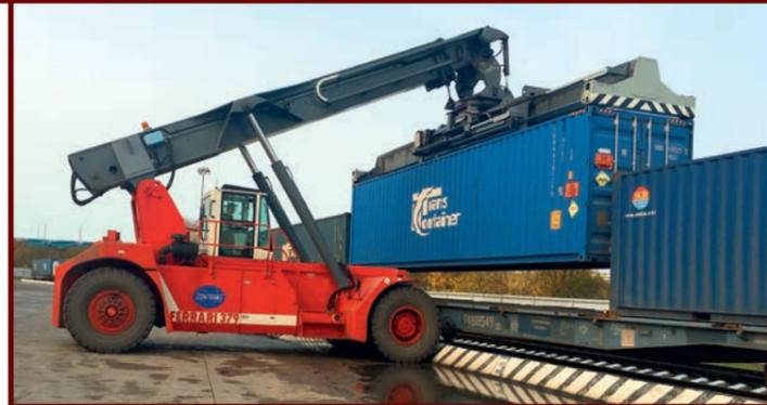
На контейнерном терминале используется погрузо-разгрузочное оборудование — ричстакеры FERRARI, KALMAR грузоподъемностью 45 тонн, что позволяет быстро и оперативно проводить обработку контейнеров и осуществлять складирование контейнеров до 5 ярусов.
